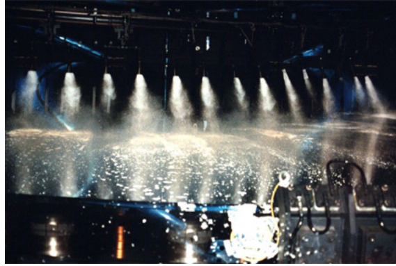
図 1.12: CO2 クリーニング中のすばる望遠鏡の主鏡
